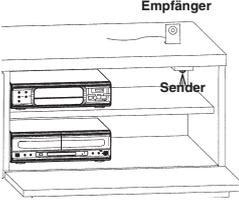
Der IR Repeater leitet die Signale von handelsüblichen IR Fernbedienungen ins Möbellinnere. Es können so z.B DVD-Player hinter geschlossener Front bedient werden. Ankommende IR-Signale werden über den Empfänger aufgefangen, und über den Sender ins Möbellinnere weitergeleitet. Der Repeater benötigt keine eigene Fernbedienung. Zum Betrieb ist ein Netzanschluß mit 220 Volt erforderlich.<br><br>IR=infrarot |
