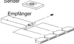
Mit dieser Fernbedienung können max. 4 Stromkreise geschaltet und gedimmt werden. Pro Stromkreis sind 6 Leuchtkörper möglich. Die Fernbedienung wird, falls gewünscht zwischen Vorschaltgerät und Beleuchtung gesteckt.                                                                                                                                                                                                 |
